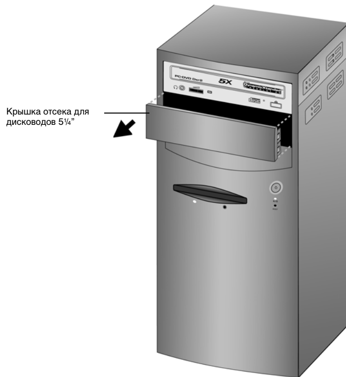
Рис. 1-8: Снятие крышки отсека для дисководов 5 1/4".
