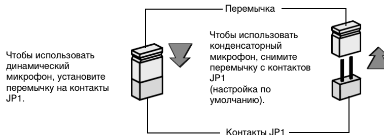
Рис. 1-4: Настройка контактов для микрофона.
