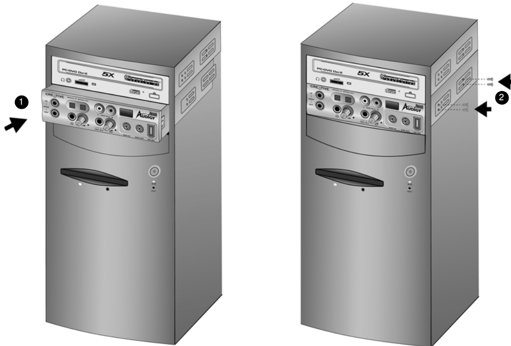
Рис. 1-10: Установка модуля Audigy 2 Drive.
